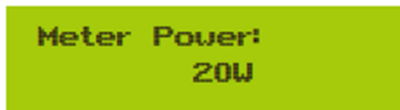
Obr. 7.5 Zapnutí funkce nulového exportu prostřednictvím elektroměru
