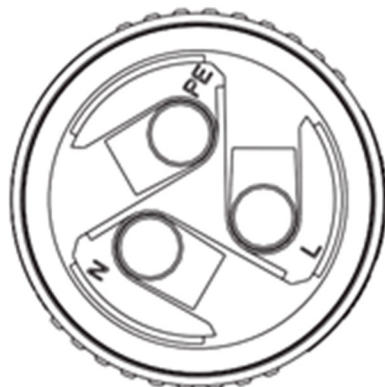
Obr. 5.9 Vzor otvorů pro konektor AC
